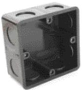
**SB 2**, распределительные и монтажные коробки, утопленного типа, двухместные, соответствуют Британскому Стандарту BS 4662; черные (RAL 9005) или белые (RAL 9010), межосевое расстояние 60мм, с латунными вставками, 12 демонтируемых отверстий для ввода труб
