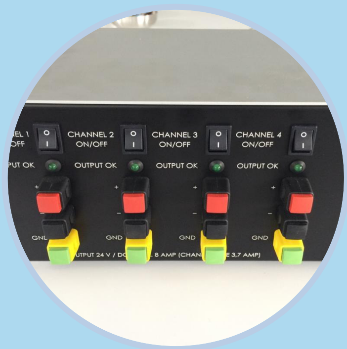
Elektrische Prüfungen mit Schnelldruckklemmen Electrical testing with quick-release terminals
